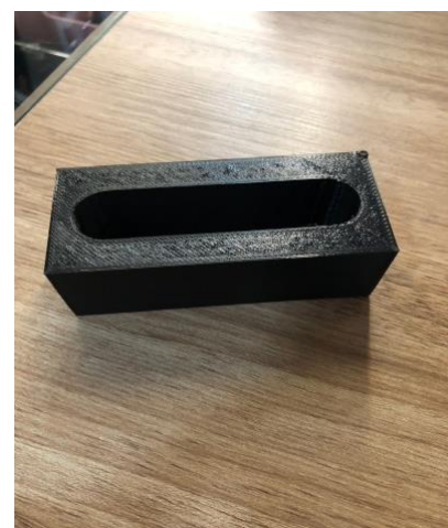
Figura 4. Suporte de mancal com furo oblongo fabricado por meio de impressão 3D. Fonte: Autores.
