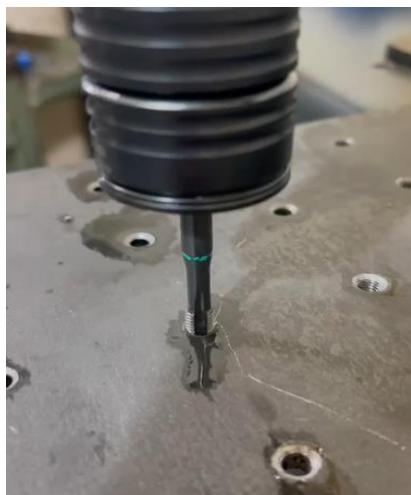
Figura 5. Macho fazendo rosca M6 em placa de fixação. Fonte: Autores.
